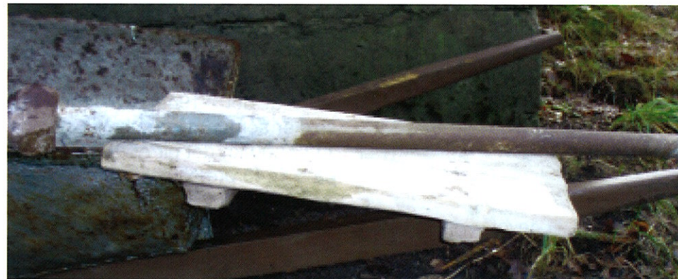
"Betongstamper" og trebrett til blokker.
